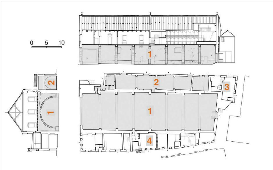
Fig. 3. Arsenal, Lesina, Pianta e sezione del piano terra: 1) sala dell'Arsenale; 2) Fontico; 3) casa privata; 4) case private (disegni Soprintendenza di Spalato elaborati da da Luka Ivančić, *Baugeschichte des Arsenal Hvar*, tesi di dottorato, TU München, 2019, p. 6)
